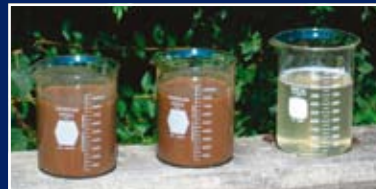
Schlamm vor und nach Behandlung mit TenCate Geotube® Entwässerungs-System
